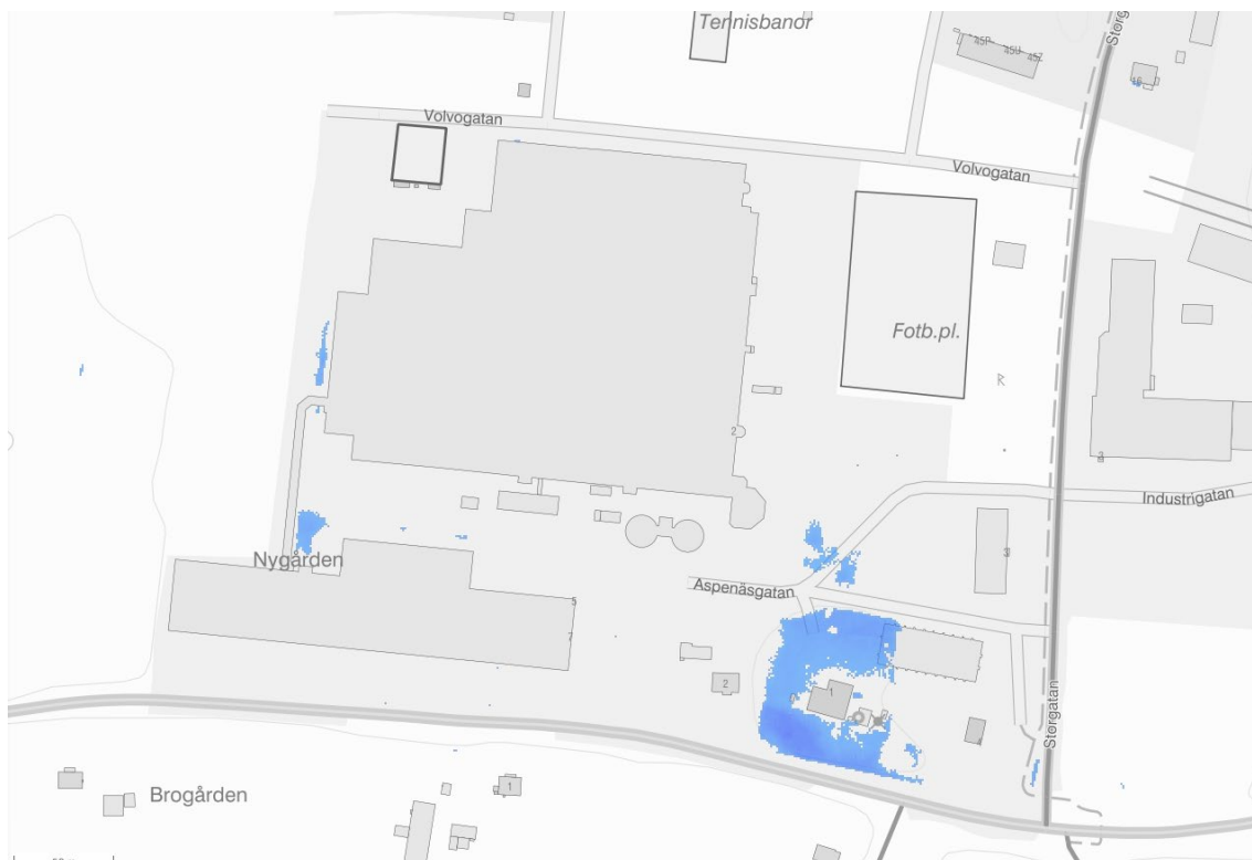
Bild 44. Visar vilka områden som har stående vatten med ett djup om 20 centimeter eller mer vid 70 mm regn med 30 minuters varaktighet vilket kan motsvara ett 200-årsregn.
