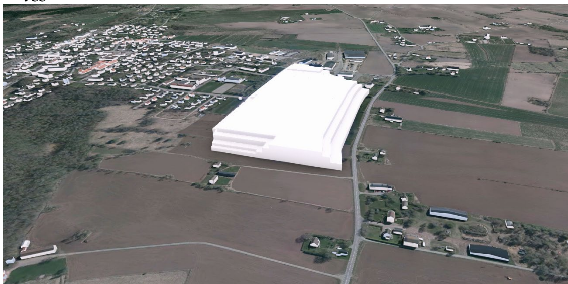
Bild 14. Bild som visar den volym som skapas av detaljplanen. Enligt detaljplanen får 50% av marken bebyggas varpå det inte är möjligt att bygga hela denna volym.
