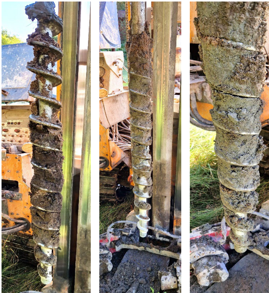
Figur 6. Jordprovtagning i punkt 2318 med skruvborr på bandvagn med markprofilen i 0-1 m djup (t.v.) respektive 1-2 m djup (m) och 2-2,5 m (t.h.). Markprofilen är representativ för områdets centrala till norra del.
